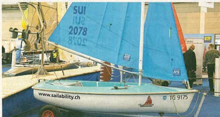
Boote der Hansa-Klasse sind weltweit verbreitet und bieten Menschen mit Behinderung Hilfsmittel zum sicheren Segeln. Ein Personenlifter hilft beim Einsteigen.
